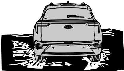
При движении по снегу используйте зимние шины, насколько это возможно. Если вы используете зимние шины, выберите тот же размер и модель, что и оригинальные шины.
