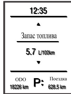
Расход топлива на коротких дистанциях показывает средний расход топлива за ездовой цикл в л/100 км. Каждый раз, когда остановка двигателя длится более 2 часов, расход топлива на коротких дистанциях автоматически сбрасывается. После очистки записи дальность движения менее 100 м отображается как --- L / 100 км. После пробега на 100 м отображается рассчитанный расход топлива на короткие расстояния.
