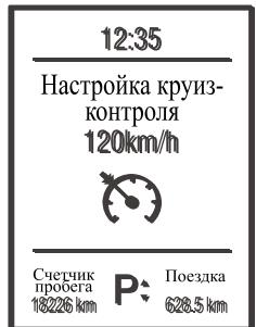
Скорость круиз-контроля отображает текущую скорость круиз-контроля автомобиля, установленную водителем. Крейсерская скорость может быть установлена переключателем круиза. Если круизная функция не активирована, на экране будет отображаться --- км / ч.
