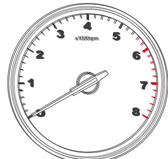
Тахометр показывает обороты двигателя в минуту, измеряемые в об/мин. Двигатель более подвержен износу и потребляет больше топлива, если во время движения частота вращения двигателя слишком высока. В большинстве случаев двигатели с низкими оборотами более экономичны.
