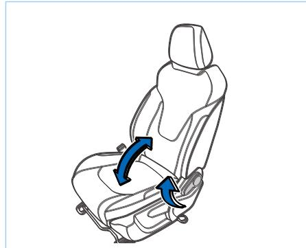
Ваш автомобиль оборудован рукояткой регулировки угла наклона спинки сиденья, расположенной снаружи сиденья.
