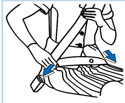
Вставьте передний пружинный болт трехточечного ремня безопасности на среднем заднем сиденье в левую пряжку, а средний пружинный болт - в правую пряжку.
