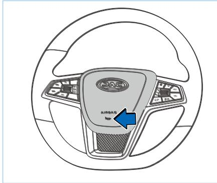
Нажмите выключатель звукового сигнала на рулевом колесе, и будет издаваться звуковой сигнал.
