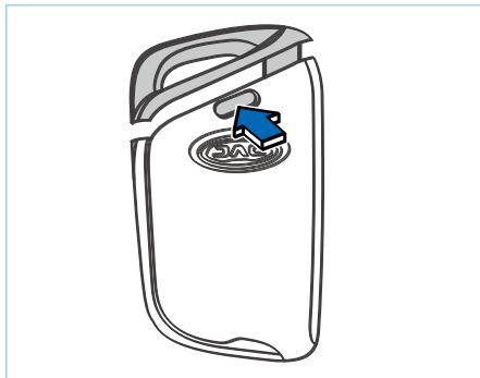
2. Вставьте прямую отвертку в отверстие для демонтажа, чтобы приподнять верхний кожух, а затем откройте кожух вдоль.
