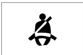
Если автомобиль начинает движение, а водитель или передний пассажир не пристегнуты, или если ремень безопасности отстегивается во время движения, система подаст звуковой сигнал, а соответствующий индикатор на приборной панели будет постоянно гореть или мигать. Контрольная лампа погаснет только после того, как водитель и передний пассажир пристегнутся.
