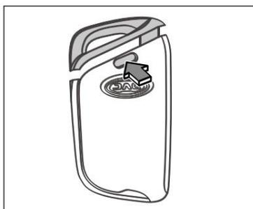
2. Аккуратно поднимите верхние защёлки корпуса и откройте корпус вдоль зазора
