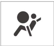
Сигнализатор (контрольная лампа) подушки безопасности контролирует состояние системы подушек безопасности, цепи преднатяжителя ремня безопасности и всех связанных с ними комплектов проводов. Когда выключатель зажигания установлен в положение "ON", система проходит самодиагностику, и после нескольких секунд загорания сигнализатор подушки безопасности гаснет, что означает, что система находится в нормальном рабочем состоянии.
