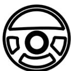
Когда выключатель зажигания находится в положении " ON ", предупреждающая лампа о неисправности системы электроусилителя рулевого управления горит постоянно. После запуска двигателя контрольная лампа гаснет, указывая на нормальную работу системы.
