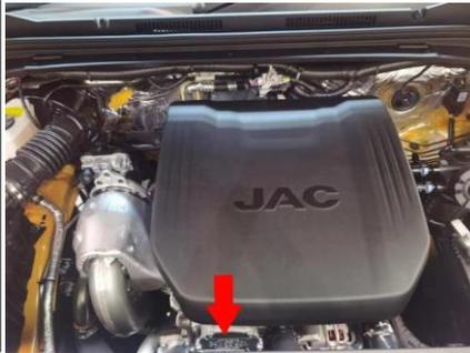
Табличка двигателя расположена на передней стороне капота.
