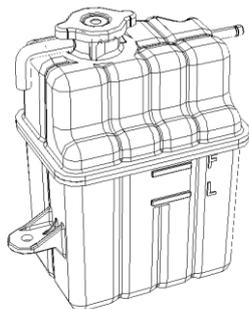
Расширительный бачок охлаждающей жидкости двигателя находится в левой части подкапотного пространства, точное положение приведено на вышеуказанном рисунке. Когда двигатель полностью
